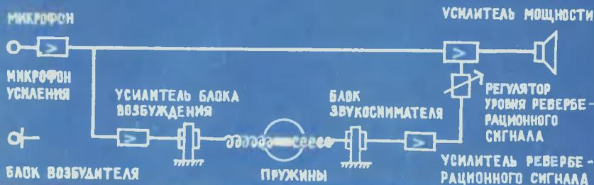
Компактность и простота — вот главные достоинства пружинного ревербератора. Задерживающим элементом в этом ревербераторе служит спиральная пружина.
